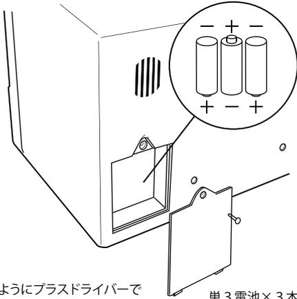
図のようにプラスドライバーで本体背面の電池ボックスのネジを外し、電池をセットします。
